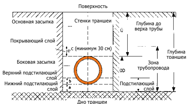
Рис. 3 Устройство траншеи
