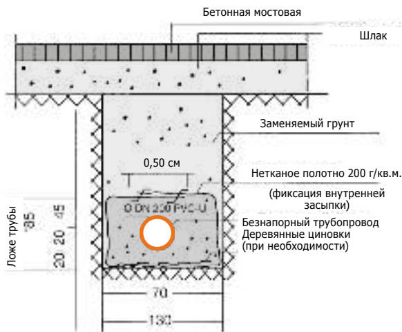
Рис. 7 Пример прокладки труб в мягком грунте
